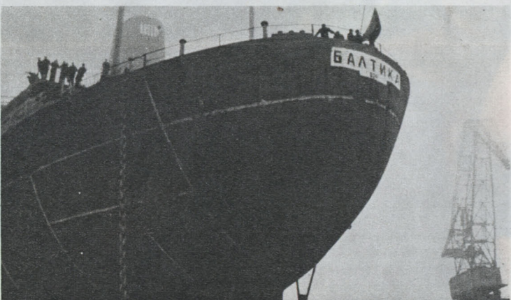
Со ступеней Балтийского судостроительного завода в Ленинграде спущен на воду рудовоз «Балтика». Коллектив завода досрочно выполнил взятое обязательство. Водизмещение судна-гиганта — 45 тысяч тонн.
